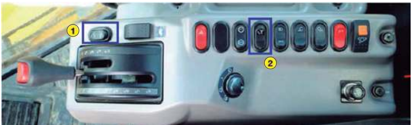
1 Interruptor seletor de ajuste do modo de rotação do motor
