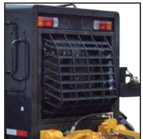
Ventilador de arrefecimento com sentido de rotação reversível
