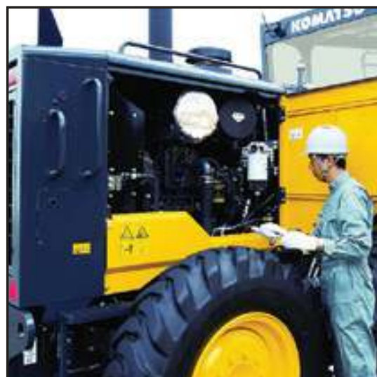
Ventilador de arrefecimento com sentido de rotação reversível
