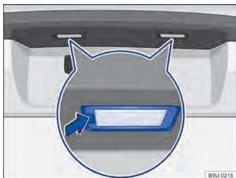
Fig. 139 No para-choque traseiro: remover a lanterna da placa de licença.
