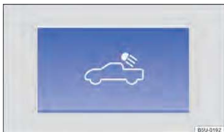
Fig. 66 No console central: tecla da iluminação do compartimento de carga.
