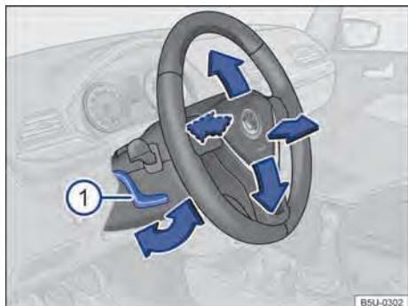
Fig. 56 Embaixo e à esquerda do volante junto com o revestimento da coluna de direção: alavanca de ajuste da posição do volante.
