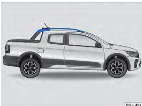
Fig. 123 Suportes longitudinais do bagageiro do teto (ambos os lados).
