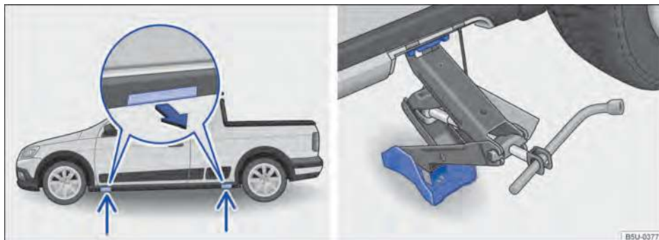
Fig. 172 Pontos de apoio do macaco e macaco posicionado no lado esquerdo traseiro do veículo - veículos com soleiras externas.
