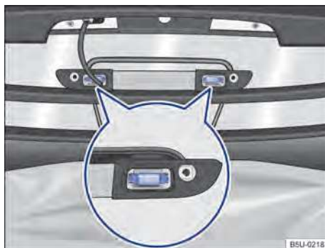
Fig. 142 Lanterna de freio elevada: remover a lâmpada incandescente da iluminação do compartimento de carga.
