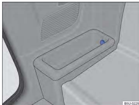
Fig. 105 Na lateral do compartimento interno de bagagem: tomada 12 V.
