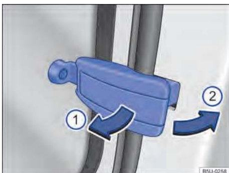
Fig. 55 Fechar o vidro basculante traseiro.
