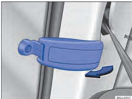
Fig. 54 Abrir o vidro basculante traseiro.
