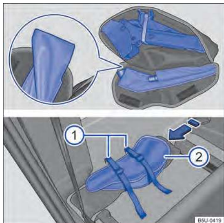
Fig. 126 Atrás do encosto do banco do passageiro: ① cintas de fixação da bolsa das ferramentas de bordo e ② bolsa das ferramentas de bordo.
