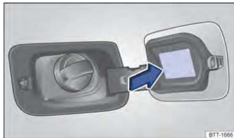
Fig. 163 Na parte interna da portinhola do tanque de combustível: etiqueta com a pressão dos pneus.
