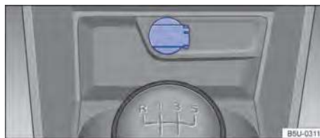
Fig. 104 No console central dianteiro: tomada 12 V.
