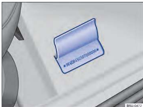
Fig. 176 Em frente ao banco do passageiro: número de identificação do veículo (número do chassi) no assoalho, em frente ao banco do passageiro dianteiro.
