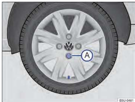
Fig. 169 Retirar a supercalota.
