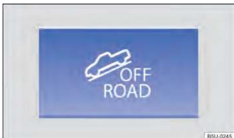
Fig. 86 No console central: botão para ligar e desligar o modo off-road manualmente.
