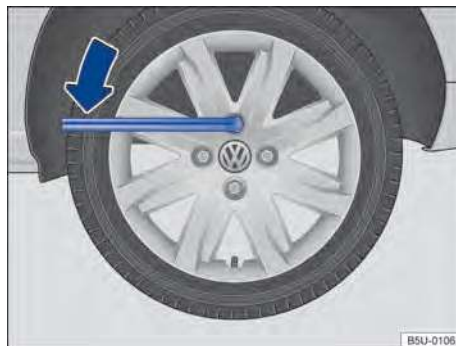
Fig. 170 Troca de roda: soltar os parafusos da roda.
