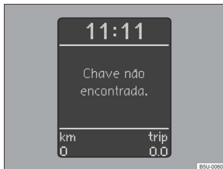
Fig. 83 No instrumento combinado: display com indicação do imobilizador ativado - veículos com Sistema de Informações Volkswagen.
