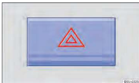
Fig. 37 Na parte superior do console central: interruptor das luzes de advertência.
