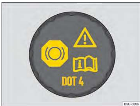
Fig. 158 No compartimento do motor: tampa do reservatório de fluido de freio.
