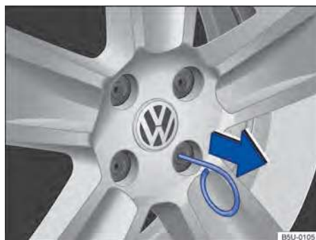
Fig. 168 Retirar as capas de cobertura dos parafusos da roda.
