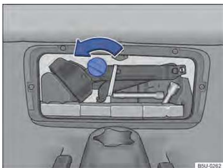
Fig. 129 Manípulo de fixação da caixa de ferramentas de bordo.
