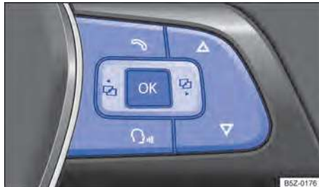
Fig. 18 Lado direito do volante multifunções: teclas de comando dos menus do instrumento combinado.
