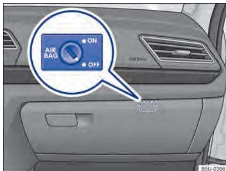
Fig. 35 No porta-luvas: interruptor desacionado pela chave para desligar e ligar o airbag frontal do passageiro.
