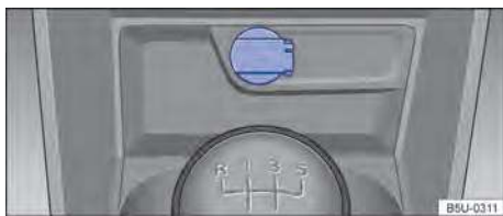
Fig. 106 No console central dianteiro: tomada 12 V.
