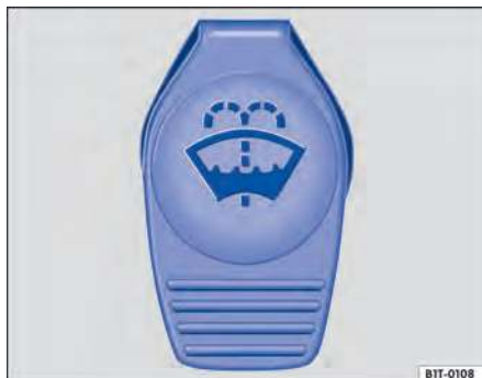
Fig. 153 No compartimento do motor: tampa do reservatório de água dos lavadores do para-brisa.
