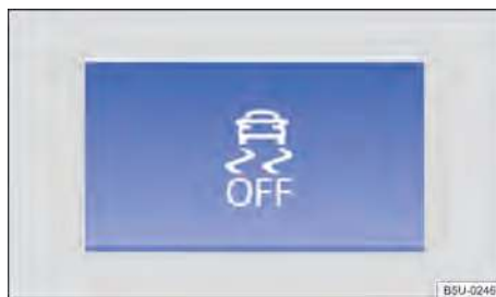
Fig. 93 No console central: botão para desligar e ligar ASR manualmente.
