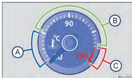
Fig. 15 Indicador de temperatura do líquido de arrefecimento do motor no instrumento combinado (variante 2): (A) área fria; (B) área normal; (C) área de alerta.
