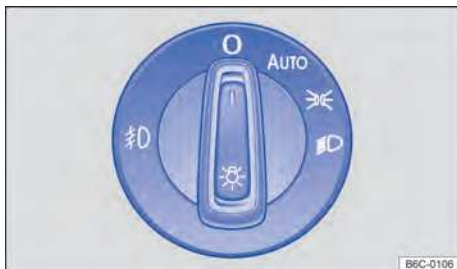
Fig. 62 Ao lado do volante: interruptor de luzes.
