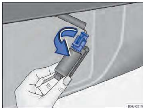
Fig. 140 Lanterna da placa de licença: remover o soquete da lâmpada.
