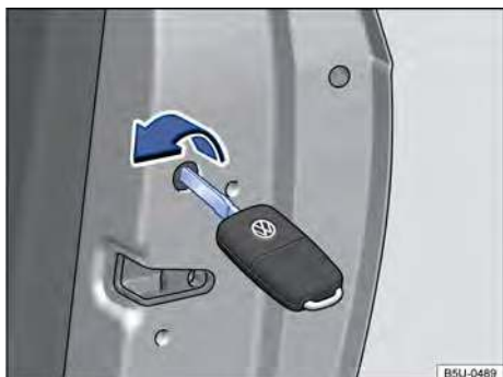
Fig. 46 Travamento de emergência do veículo com a chave do veículo.
