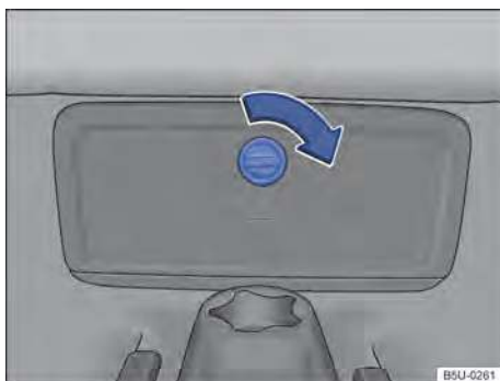
Fig. 128 No assoalho do banco traseiro: acesso à caixa de fixação das ferramentas de bordo.
