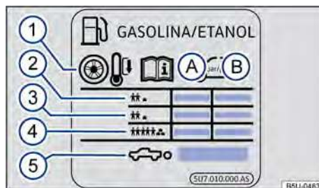
Fig. 162 Etiqueta com as pressões dos pneus.
