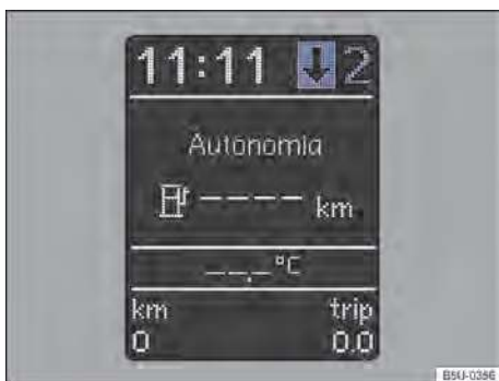
Fig. 80 No instrumento combinado: indicador de troca de marcha (variante 2).
