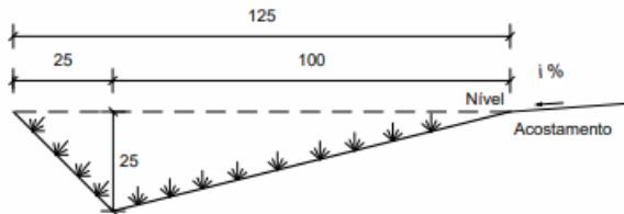
Estas sarjetas deverão conduzir as águas pluviais para bueiros já existentes, para sangradouros ou para eventuais caixas de retenção.
